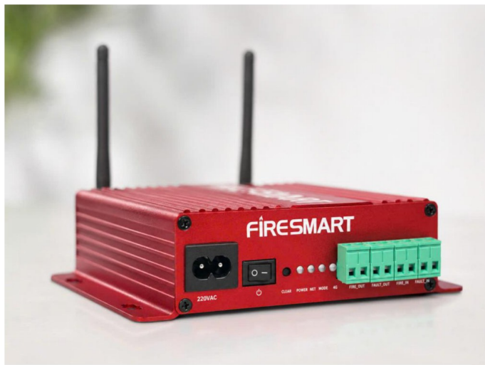
Hình 1-1: Thiết bị truyền tin FCOM
